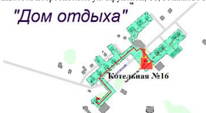
Рисунок 62. Трассировка участка тепловой сети от камеры «Вывод - Котельная № 16» до потребителя ул. Крупской, 16, Южакова Г.Г.
