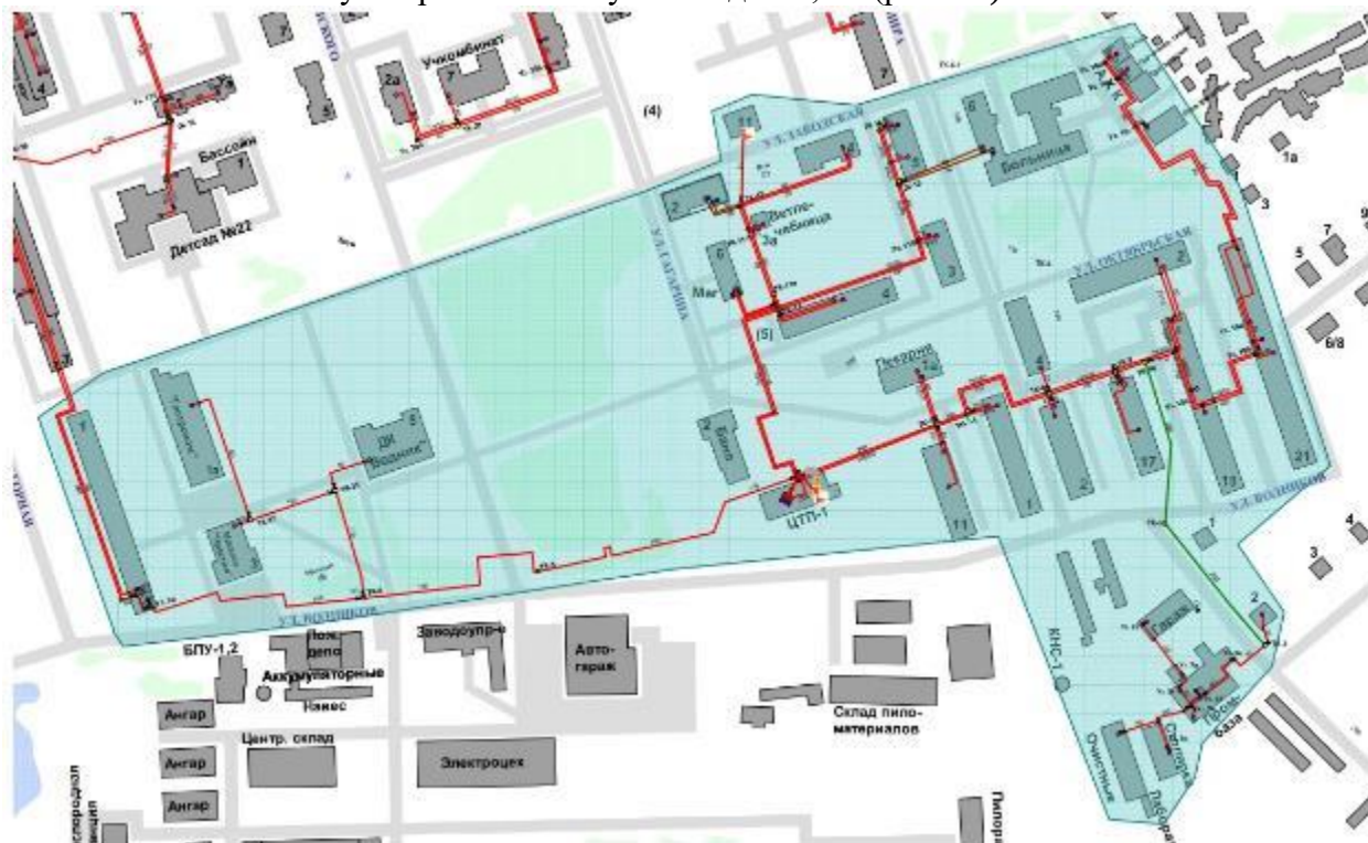
Рисунок 68. Трассировка участка тепловой сети от камеры «Вывод - Котельная № 9» до потребителя по ул. Заводская, 11
