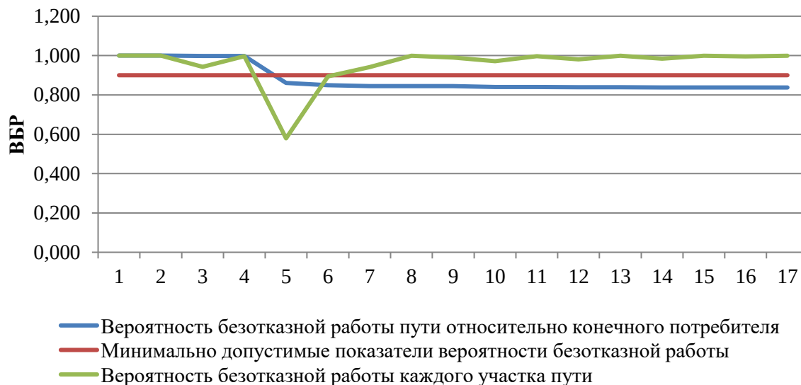
Рисунок 59. ВБР относительно участка тепловой сети от камеры «Вывод -Котельная № 20» до потребителя «Ж/д № 10, КХ «Расчет»
