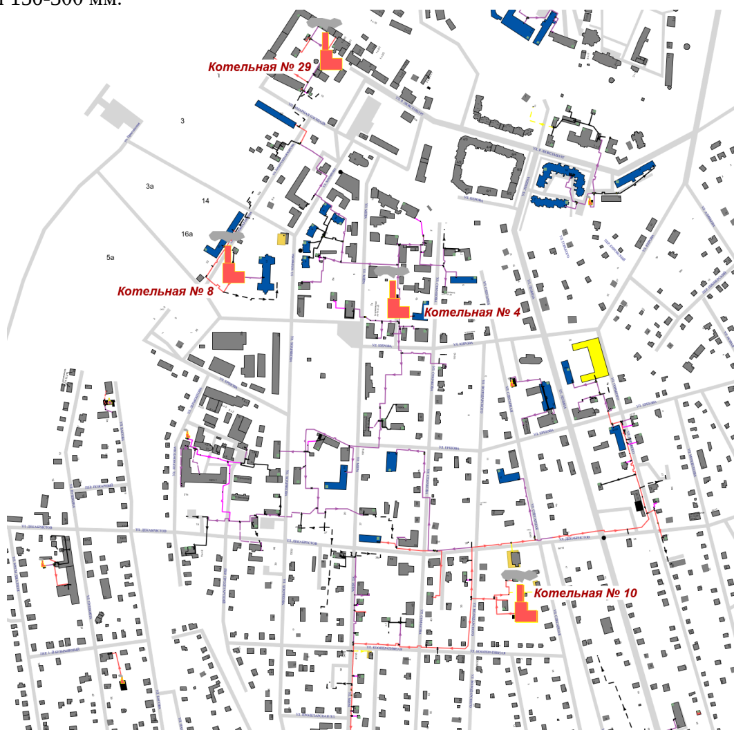
Рисунок 18. Перераспределение нагрузок между котельными №№ 4, 8, 10, 29
