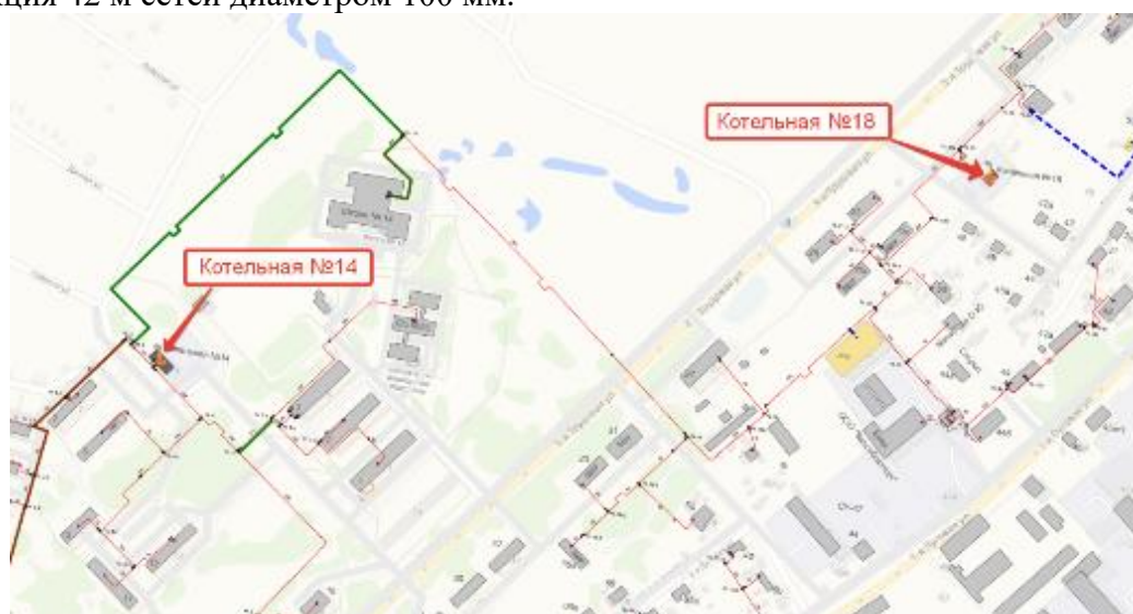
Рисунок 16. Перераспределение нагрузки между котельными № 14 и № 18
