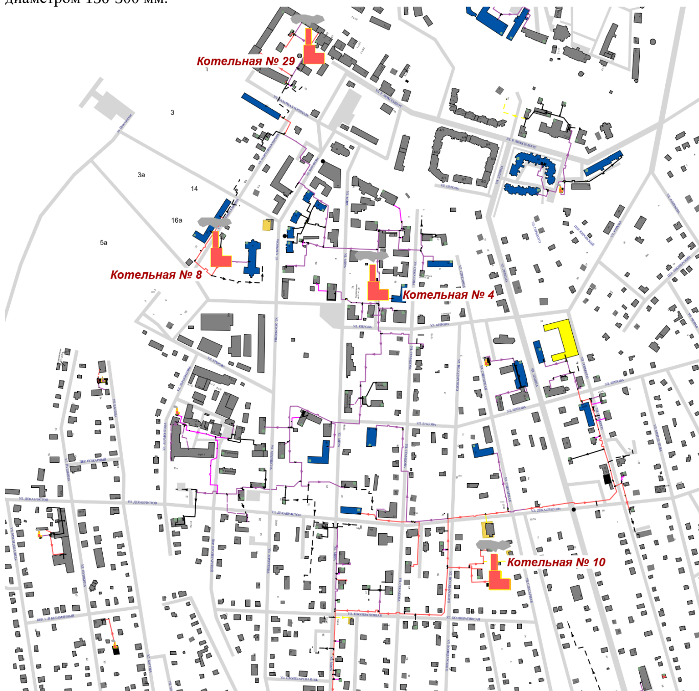
Рисунок 14. Перераспределение нагрузок между котельными №№ 4, 8, 10, 29
