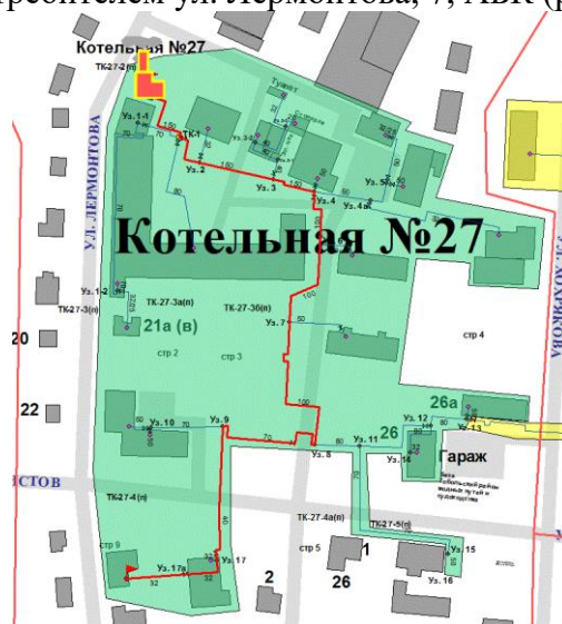
Рисунок 50. Трассировка участка тепловой сети от камеры «Вывод - Котельная № 27» до потребителя ул. Лермонтова, 7, АБК
