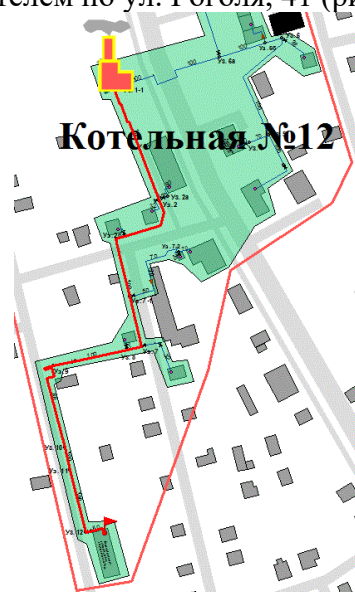
Рисунок 34. Трассировка участка тепловой сети от камеры «Вывод - Котельная № 12» до потребителя по ул. Гоголя, 41
