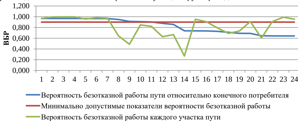
Рисунок 43. ВБР относительно участка тепловой сети от камеры «Вывод Котельная № 18» до потребителя по ул. Ленина, 200
