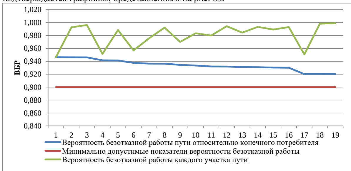
Рисунок 59. ВБР относительно участка тепловой сети от камеры «Вывод - Котельная № 16» до потребителя ул. Крупской, 16, Южакова Г.Г.
