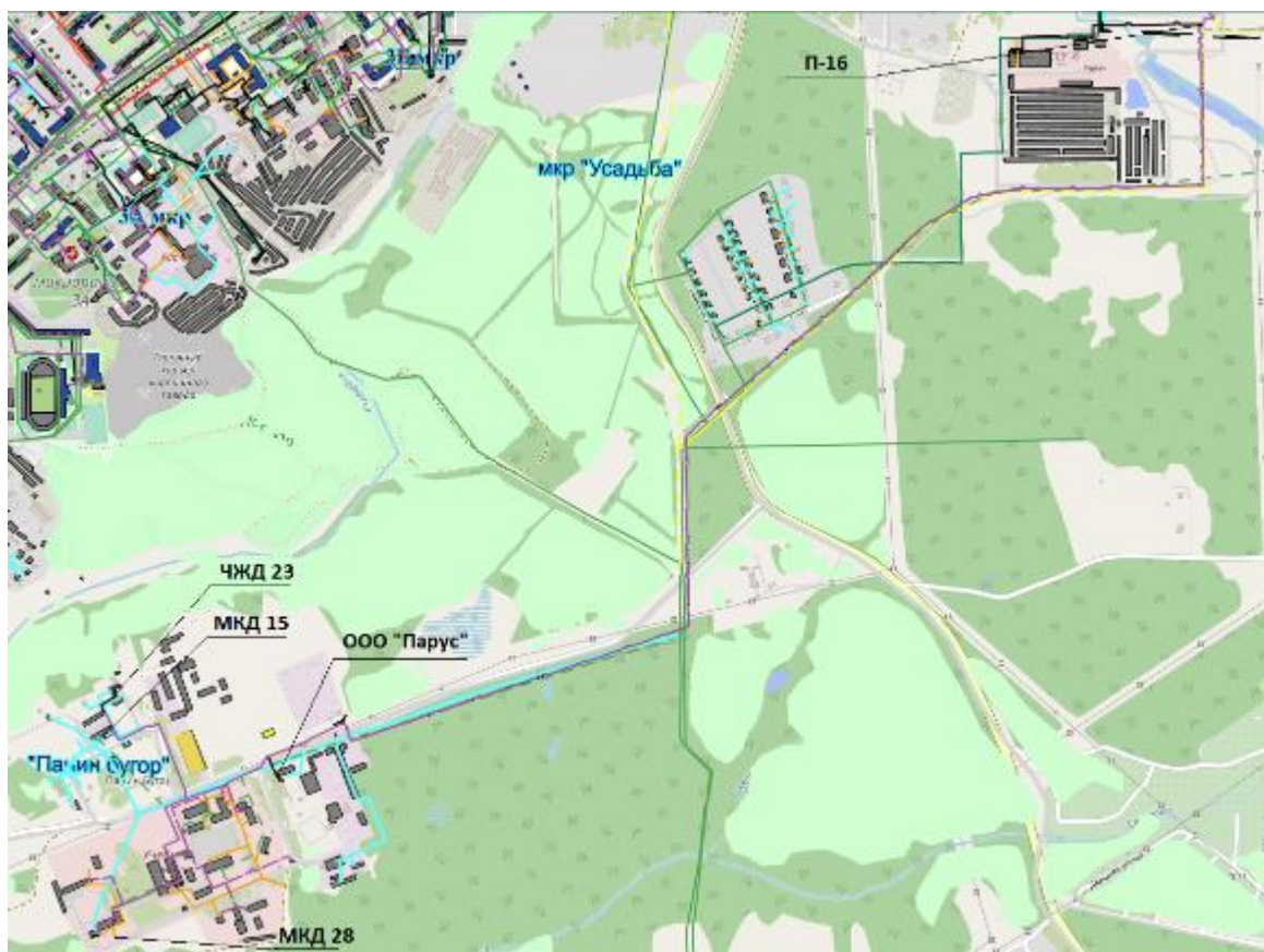
Рисунок 16. Действующая схема подключения мкр. «Панин бугор» от П-16
