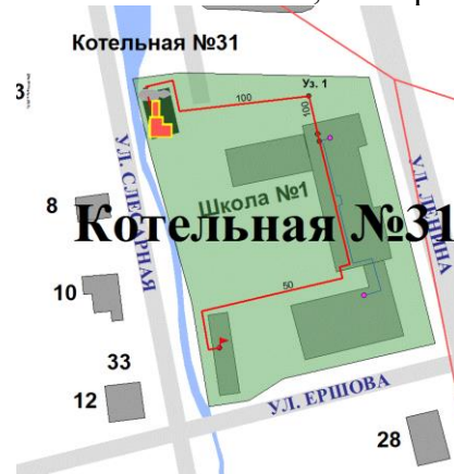
Рисунок 50. Трассировка участка тепловой сети от камеры «Вывод - Котельная № 31» до потребителя «Школа № 1, мастерские»
