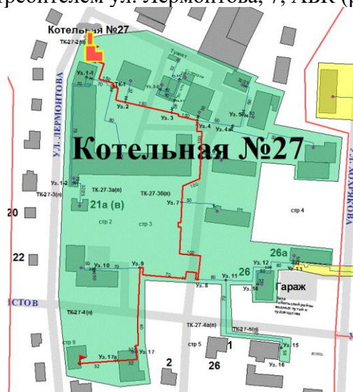
Рисунок 46. Трассировка участка тепловой сети от камеры «Вывод - Котельная № 27» до потребителя ул. Лермонтова, 7, АБК
