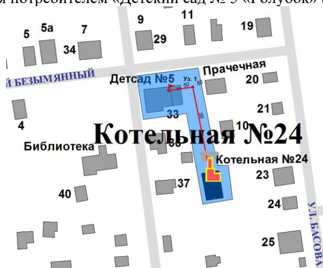
Рисунок 44. Трассировка участка тепловой сети от камеры «Вывод - Котельная № 24» до потребителя «Детский сад № 5 «Голубок»
