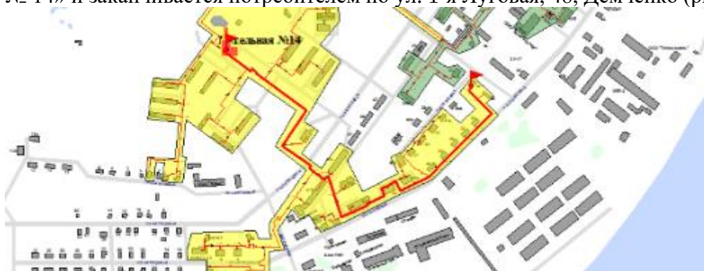
Рисунок 38. Трассировка участка тепловой сети от камеры «Вывод - Котельная № 14» до потребителя по ул. 1-я Луговая, 48
