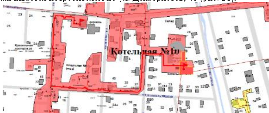
Рисунок 32. Трассировка участка тепловой сети от камеры «Вывод - Котельная № 10» до потребителя по ул. Декабристов, 40
